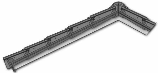
Päätyreunatiilen asennus aloitetaan katkaisemalla alin päätyreunatiili yläpäästä tiilijaon mukaiseksi.
